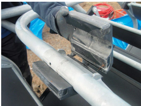
リフト搬器整備
