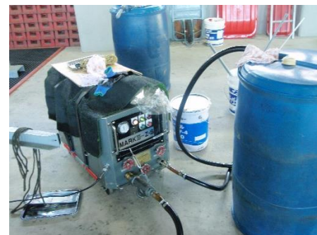
予備原動機油圧作動油整備
