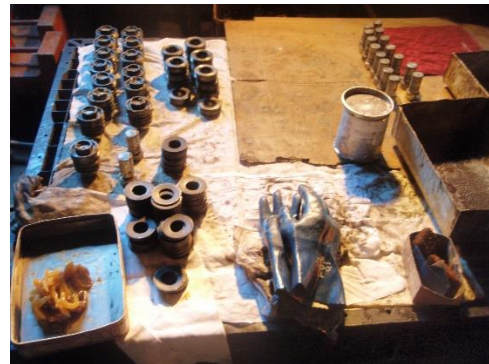
リフト握索機点検整備
