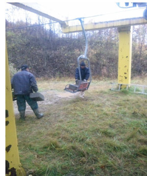
リフト荷重試験
